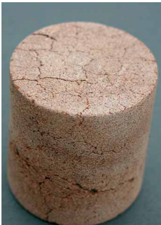
Abb. 3 Probezylinder aus feinkörnigem, ausgerichtetem und faltigen MammutiStein nach dem Härtezahltest. Das Probematerial hat im Test eine Härtezahl von 28 erreicht, also fast den Höchstwert.
