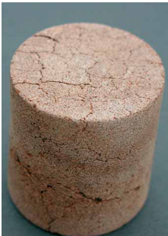
Fig 3. Campione cilindrico di PietraMammutti a grana fine, strutturata e a venatura corrugata, dopo l'esecuzione del test di durezza. Nel test, il materiale ha riportato un indice di durezza di 28, ossia quasi il massimo valore ottenibile.
